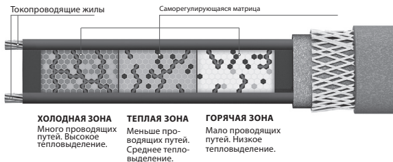
Рисунок 2. Принцип саморегулирования кабеля
